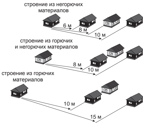
Рис. 1.31. Минимальные расстояния между постройками согласно противопожарным нормам
