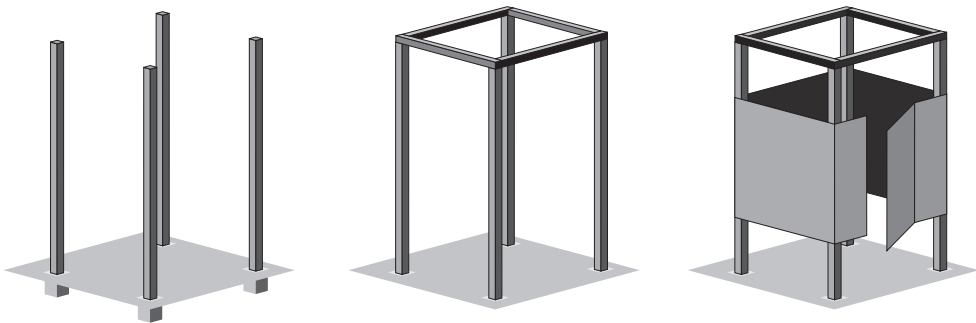
Рис. 5.74. Установка летнего душа из металлических труб и уголка
