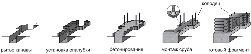
Рис. 2.63. Монтаж сруба на колодцах
