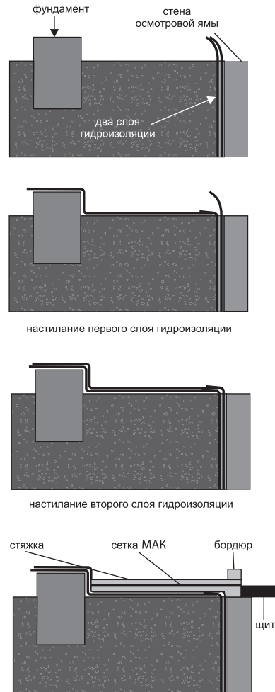
Рис. 13.6. Устройство стяжки
