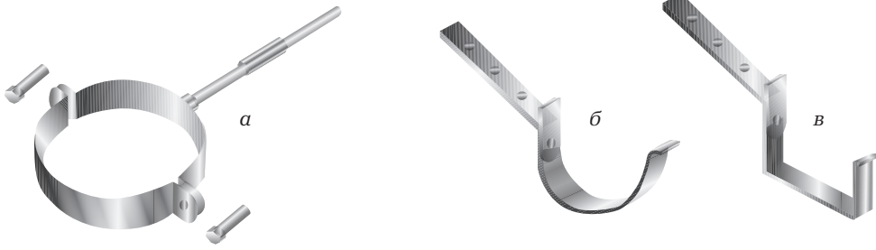
Рис. 5.31. Крепления водосточных труб: а — хомут для круглой трубы; б — держатель для круглого желоба; в — держатель для квадратного желоба
